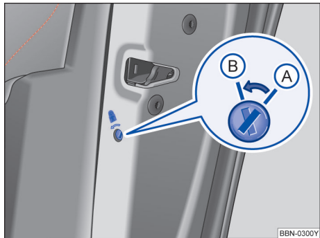
图 52 在右后车门中：儿童安全锁 (A) 已关闭、(B) 已接通
