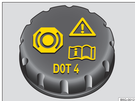
图 170 发动机舱内：制动液容器的盖子。
