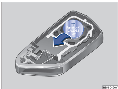
图 47 汽车钥匙：更换纽扣电池
