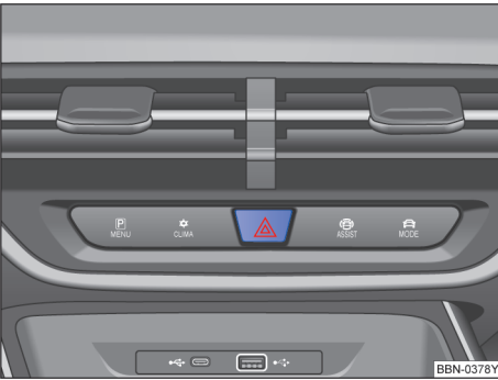
图 41 在中控台部分中：危险警告灯开关
