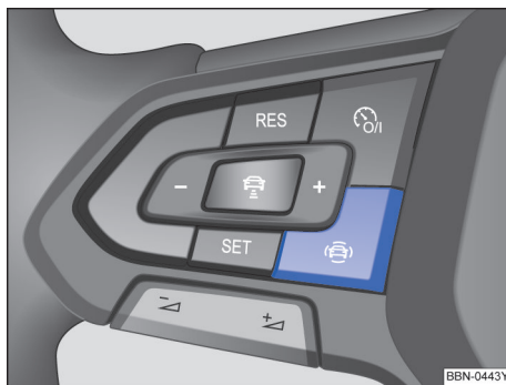
图 18 多功能方向盘上：驾驶辅助系统操作按钮
