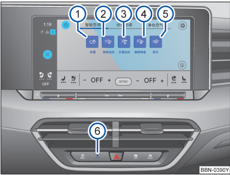
图 95 信息娱乐系统中：自动空调系统操作机构（示意图）
