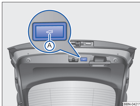
图 59 打开的行李厢盖内：用于电动关闭行李厢盖的按钮
