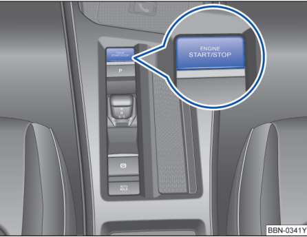
图 100 无钥匙系统 Kessy：中控台上的启动按钮
