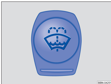
图 166 发动机舱内：车窗清洗液容器盖。
