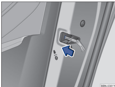
图 55 车门应急上锁装置及汽车钥匙
