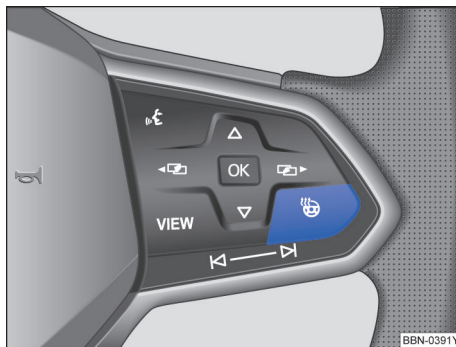
图 97 多功能方向盘上的：加热按钮
