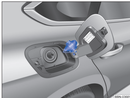
图 149 拧下的加油口盖可挂在打开的燃油箱盖板上
