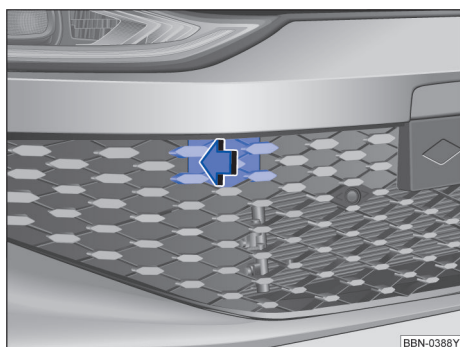
图 162 在保险杠的右前部：拆卸盖板
