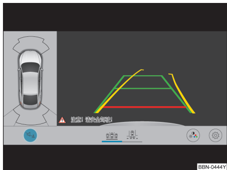
图 127 倒车摄像头屏幕显示（示意图）
