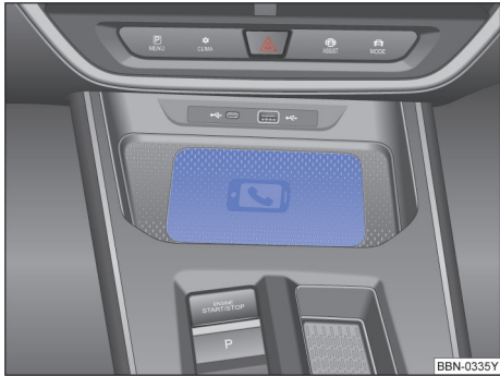
图 136 换挡装置前的储物盒（放置移动电话的底座）
