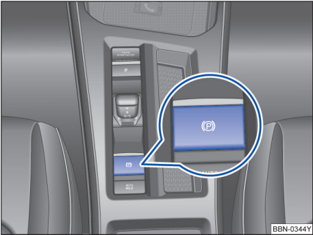
图 121 在中控台下部：电子驻车制动器按钮
