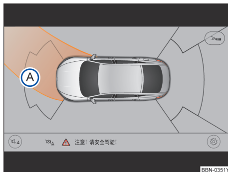
图 126 泊车雷达系统显示屏：施加转向时汽车行驶路径显示模式
