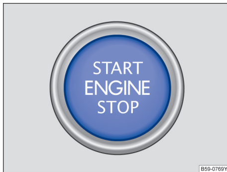
图 121 无钥匙系统 Kessy：中控台上的启动按钮
