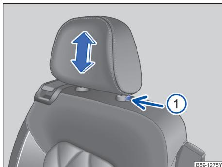
图 91 拆卸和安装后排头枕
