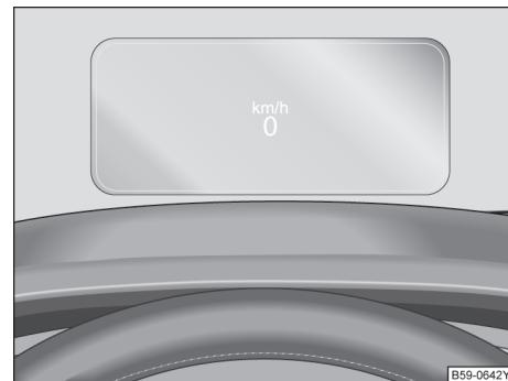
图 15 平视显示系统中的显示
