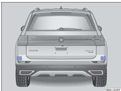
图 151 车辆后视图：雷达传感器部位
