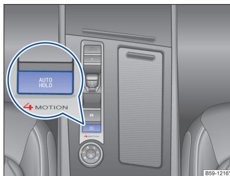
图 157 在中控台中：自动驻车功能按钮
