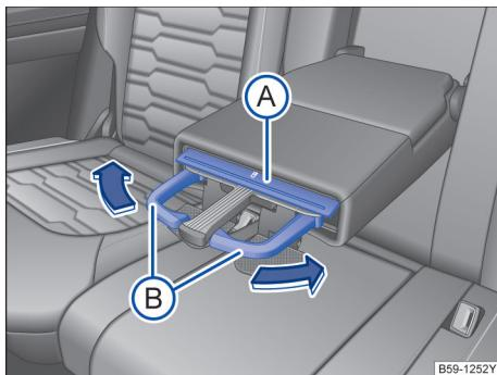
图 183 后排中央扶手上的饮料杯支架
