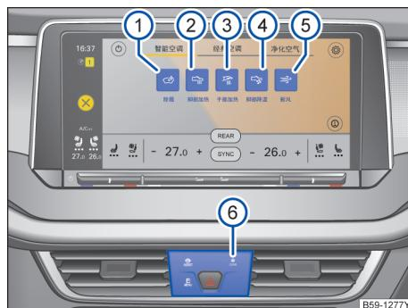
图 124 信息娱乐系统中：自动空调系统操作机构（示意图）
