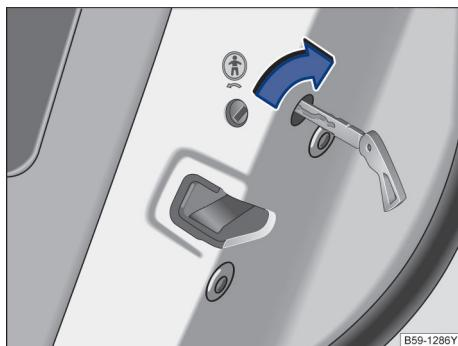
图 59 车门应急上锁装置及汽车钥匙
