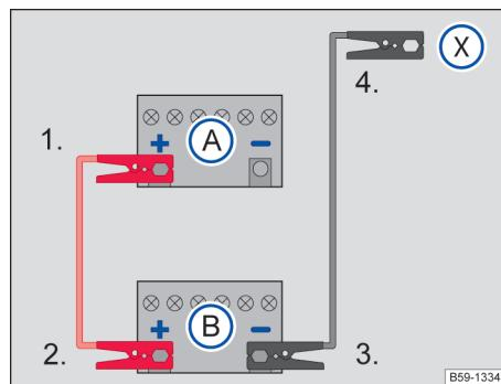
图 210 跨接电缆连接示意图
