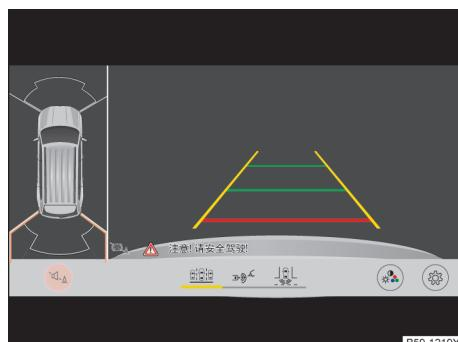
图 159 显示屏显示：车周区域驻车距离警报系统缩
