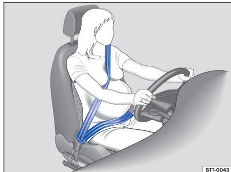
图 35 正确的孕妇安全带佩戴走向。
