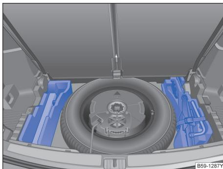
图 201 行李厢垫下的备用轮胎及随车工具
