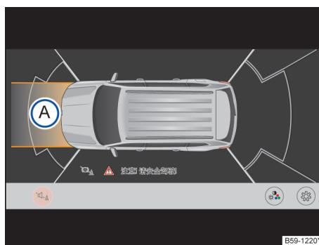
图 160 泊车雷达系统显示屏：未施加转向时汽车行驶路径显示模式
