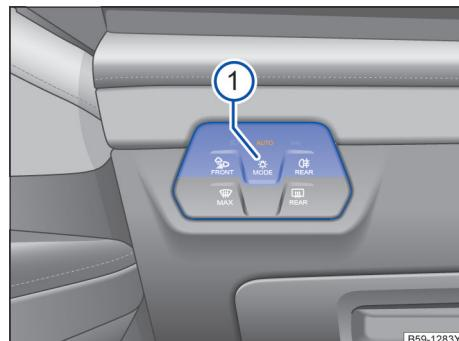
图 111 仪表板局部视图：灯光开关
