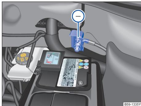
图 211 用于充电器负极连接的接地点
