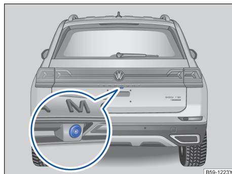
图 164 车辆行李厢内：倒车摄像头的安装位置
