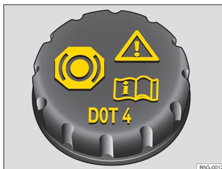
图 222 发动机舱内：制动液容器的盖子。
