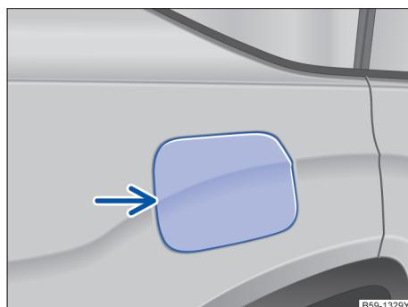
图 199 打开燃油箱盖板
