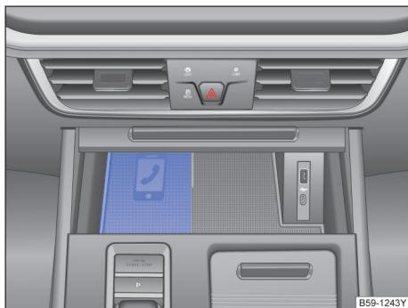
图 173 换挡装置前的储物盒 (放置移动电话的底座)
