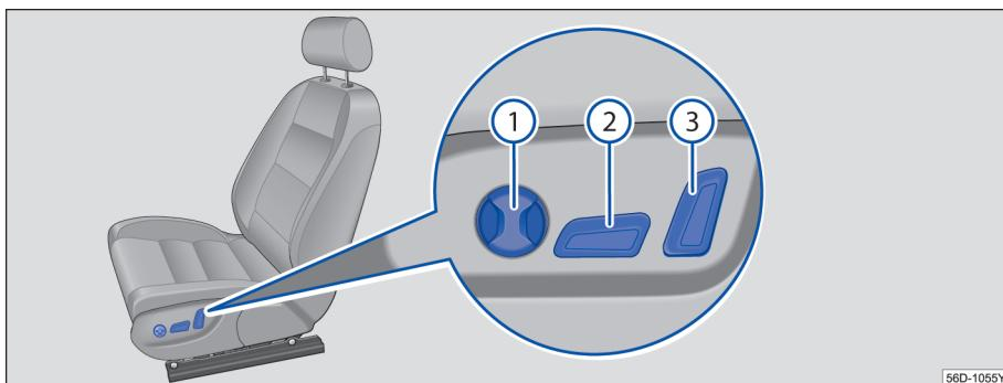
图 77 电动调整式座椅的操作元件
