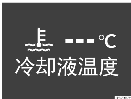
图 14 数字组合仪表中的冷却液温度表
