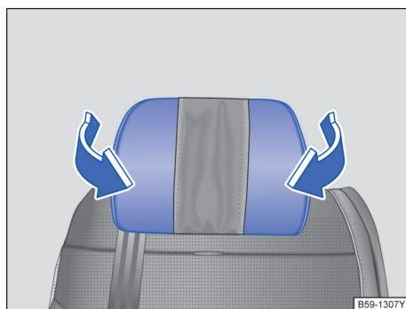
图 92 带侧面防护功能的头枕
