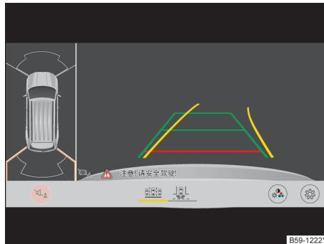
图 162 倒车摄像头屏幕显示（示意图）
