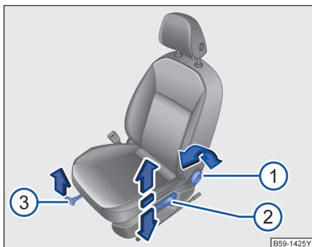
图 76 左侧前座椅上的操作元件
