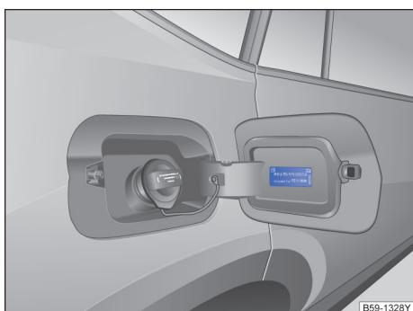
图 198 油箱加油口盖板内侧的标签
