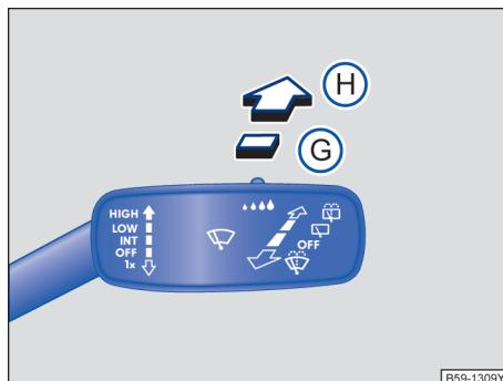
图 116 后风窗刮水器操纵杆操作位置
