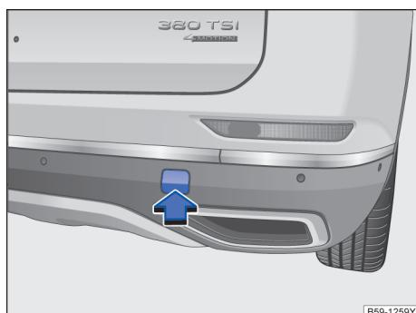
图 214 在保险杠右后部：拆卸盖板
