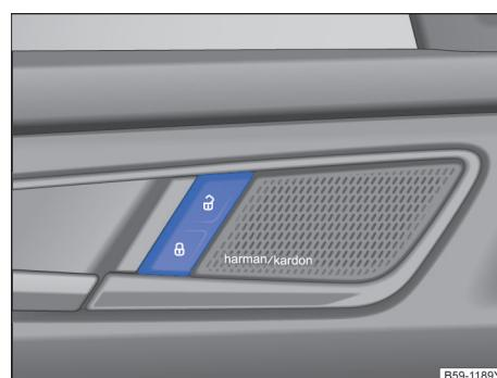
图 53 驾驶员侧车门内：中央门锁按钮
