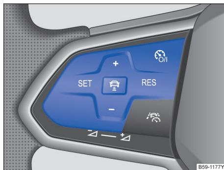
图 143 自适应巡航系统（ACC）控制按钮
