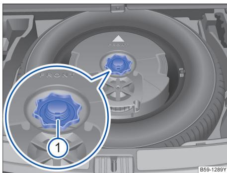
图 227 行李厢内：备用车轮（类型 B）固定手轮
