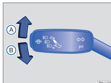
图 113 转向信号灯 / 远光灯操作杆
