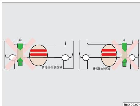
图 67 踢腿动作发生在传感器检测区域外
