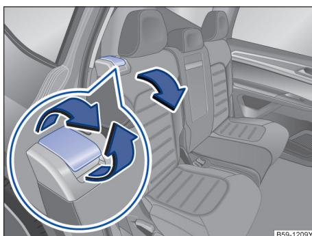
图 82 第二排座椅：上车辅助功能的操作元件
