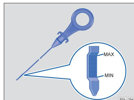
图 219 带液位标记的机油标尺
