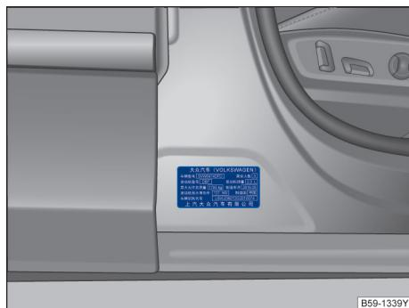
图 238 B 柱下方整车产品标牌
