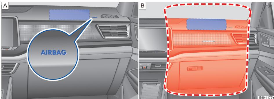
图 38 副驾驶前部安全气囊的安装位置和膨胀范围
