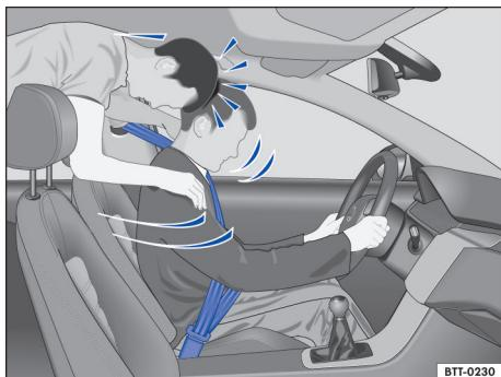
图 30 未系安全带的后排乘客被猛烈前抛，撞击佩戴安全带的驾驶员
