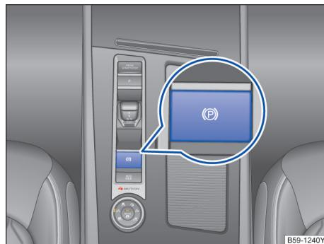
图 156 在中控台下部：电子驻车制动器按钮
