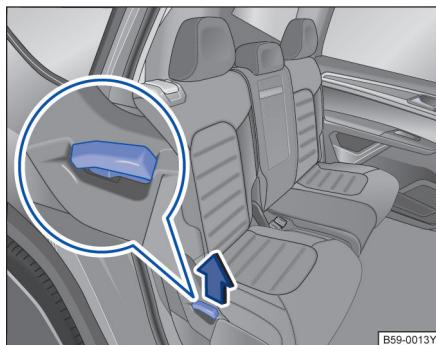
图 84 第二排座椅。将后座椅向前翻折。
