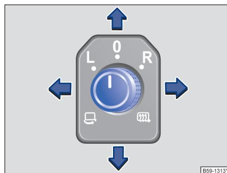
图 121 在驾驶员侧车门内：车外后视镜旋钮
