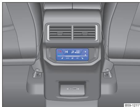
图 125 用于调节后排座位温度的操作元件
