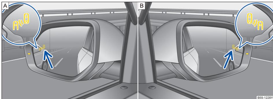
图 150 车外后视镜内：变道辅助传感器显示
