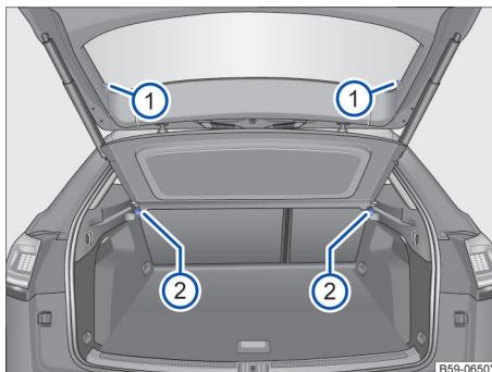
图 189 拆卸和安装行李厢盖板
