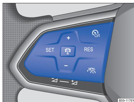
图 149 多功能方向盘左侧：操作全旅程智能驾驶辅助系统(Travel Assist)的按钮
