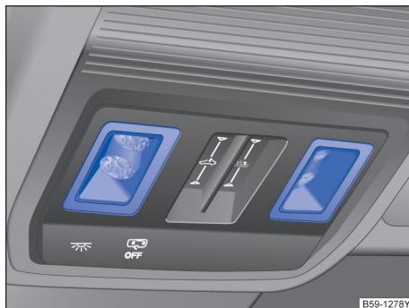
图 114 顶篷中控台：触摸感应式阅读灯
