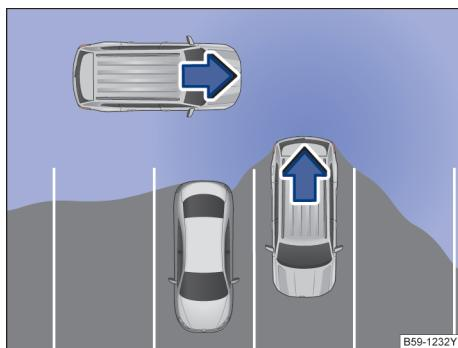
图 154 驶出车位辅助原理图：车辆驶出停车位时的车后左右两侧监控范围
