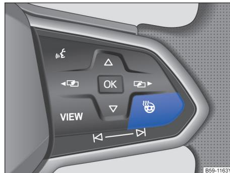
图 126 多功能方向盘上的：加热按钮
