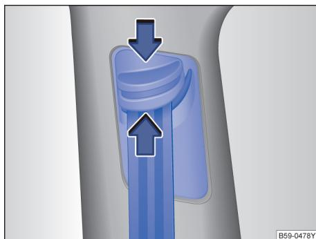
图 36 前座椅：安全带高度调整机构。
