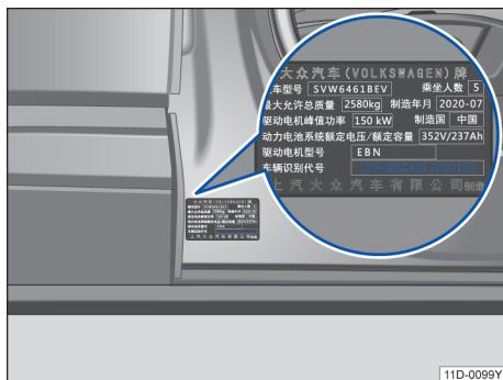
图 152 B 柱下方整车产品标牌
