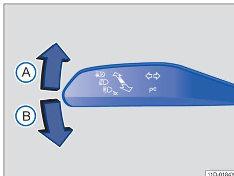
图 75 转向信号灯 / 远光灯操作杆
