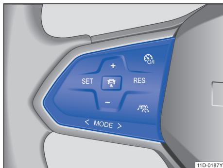
图 97 多功能方向盘左侧：自适应巡航的操作按钮
