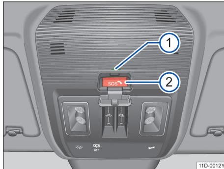
图 37 紧急呼叫操作元件：指示灯和按钮
