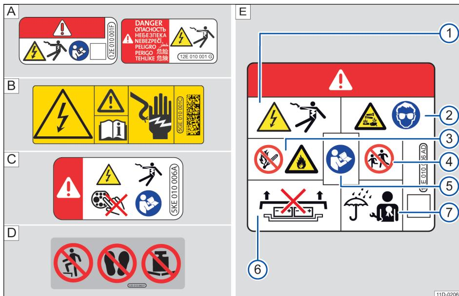
图 121 部分车型警告牌（示意图）：[A]. 高压组件 [B]. 高电压普通警告牌 [C]. 充电口高压警示标签 [D]、[E]. 高压电池上的警告牌
