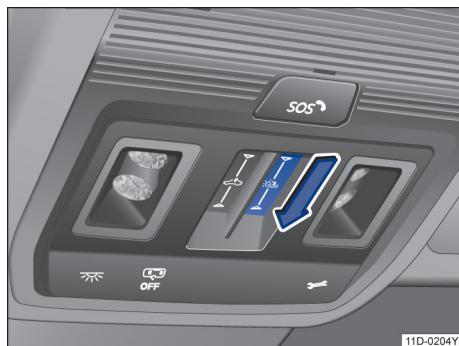
图 86 在顶篷中：关闭遮阳卷帘
