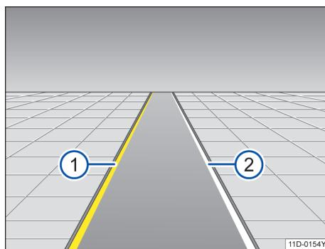
图 99 在组合仪表显示屏上：车道保持辅助系统的显示屏显示
