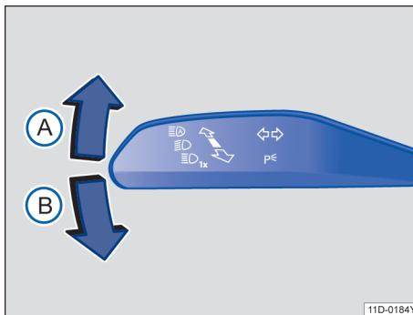
图 72 转向信号灯 / 远光灯操作杆
