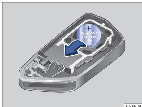
图 41 汽车钥匙：更换纽扣电池
