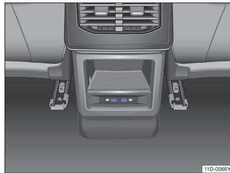
图 114 后排出风口附近的 Type-C 插口
