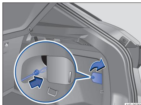
图 127 行李厢内的交流充电插头应急解锁拉索
