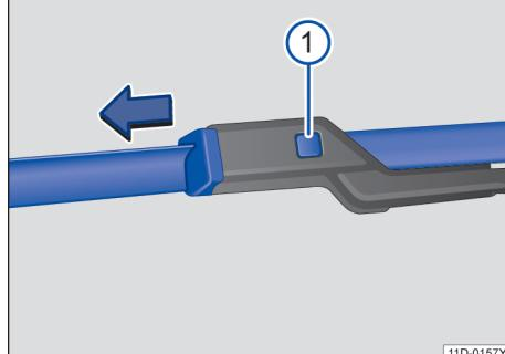
图 131 更换风窗刮水器刮水片
