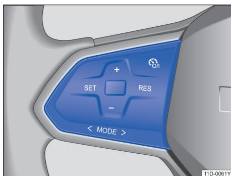
图 92 多功能方向盘左侧：定速巡航系统操作按钮
