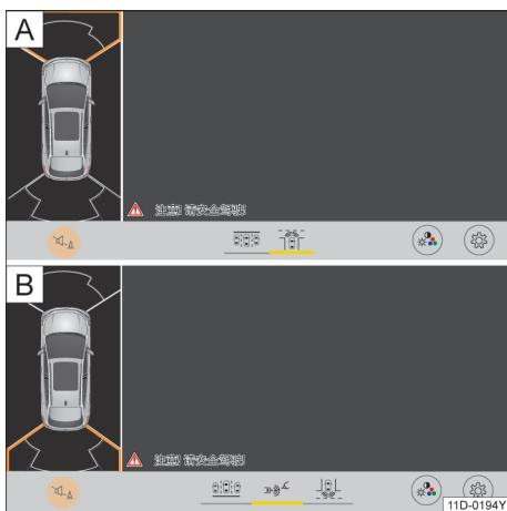
图 108 车周视野屏幕显示: **A** 前部摄像头, **B** 后部摄像头
