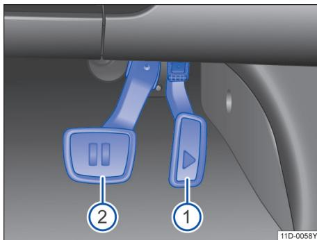
图 88 ① 加速踏板 ② 制动踏板
