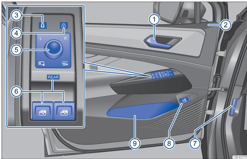
图 3 驾驶员侧车门内的操作元件概览
