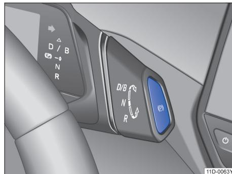
图 104 电子驻车制动器按钮
