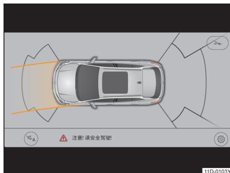
图 105 在信息娱乐系统屏幕中：障碍物识别和泊车雷达系统的转向角度（示意图）
