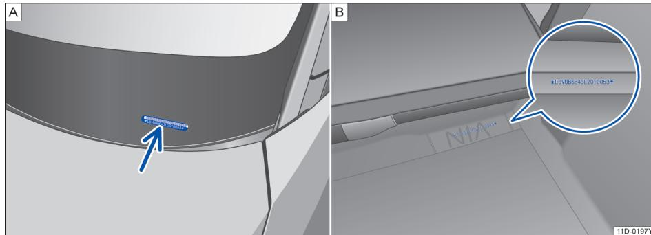
图 151 [A]. 车辆识别代号 [B]. 第二排座椅后侧的车辆识别代号钢印位置
