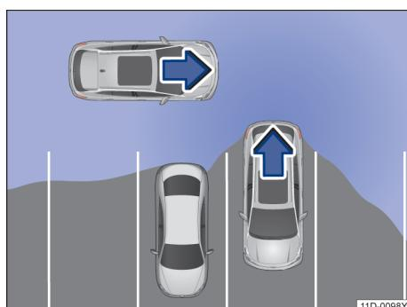
图 110 驶出车位辅助示意图：车辆驶出停车位时的四周监控范围
