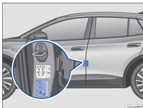
图 149 车辆 B 柱上：胎压标签
