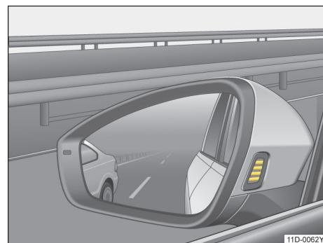
**图 103 车外后视镜外壳内：变道辅助系统的可视显示**
