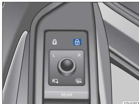
图 44 驾驶员侧车门内：中央门锁按钮
