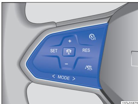
图 93 多功能方向盘左侧：车速限制器操作按钮
