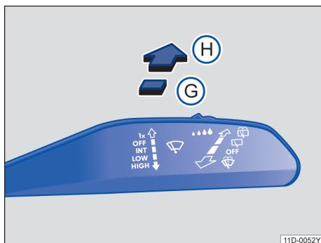
图 78 后风窗刮水器操纵杆操作位置
