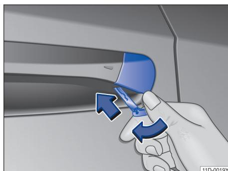
图 45 驾驶员车门拉手：撬起盖罩
