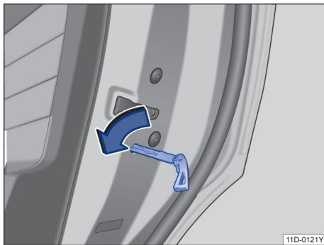
图 47 车门应急上锁装置及汽车钥匙
