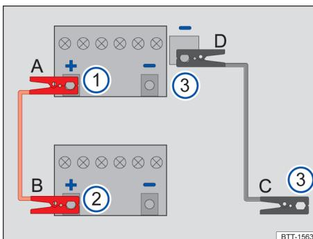
图 137 应急启动 - 电缆连接示意图
