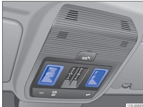
图 76 顶篷中控台中：触摸感应式阅读灯
