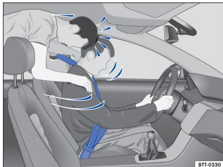
图 20 未系安全带的后排乘客被猛烈前抛，撞击佩戴安全带的驾驶员
