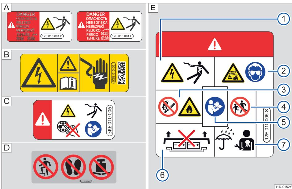
图 120 警告牌（示意图）：A. 高压组件 B. 高电压普通警告牌 C. 充电口高压警示标签 D、E. 高压电池上的警告牌
