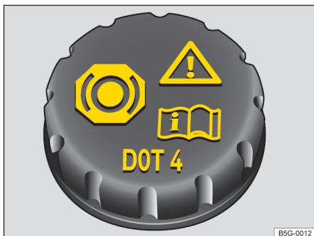
图 145 前舱内：制动液容器的盖子
