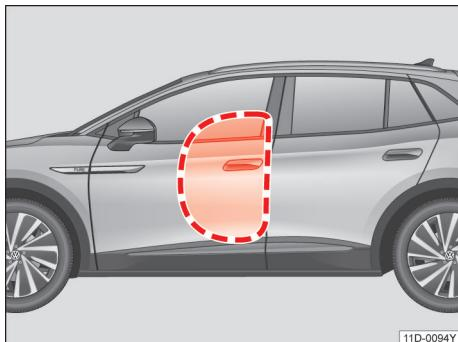
图 29 汽车左侧：侧面安全气囊的膨胀范围
