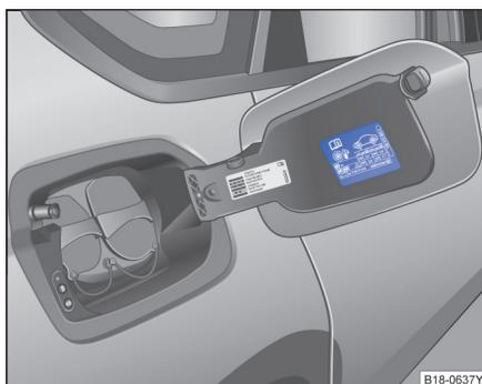
图 141 高压电池充电盖板内侧上：胎压标签
