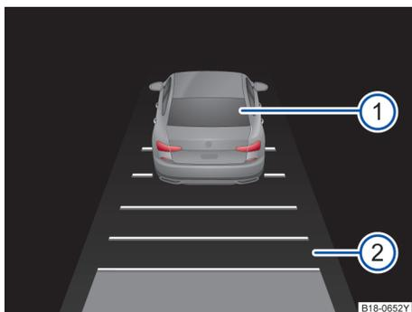
图 117 组合仪表显示屏：已暂时关闭自适应巡航系统（ACC）控制功能，已探测到的前方车辆，设定的距离间隔
