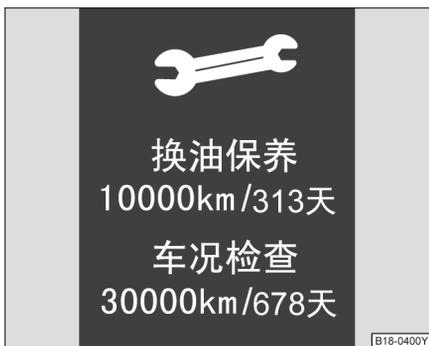
图 15 示意图：保养信息组合仪表显示屏显示示例
