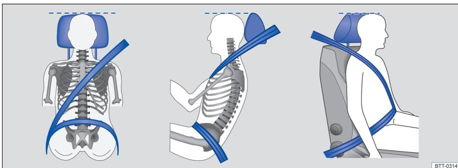
图 60 正确的安全带佩戴走向和正确的头枕调节。
