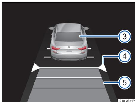
图 118 组合仪表显示屏：自适应巡航系统（ACC）处于激活状态，已探测到前方车辆，正在设定距离间隔
