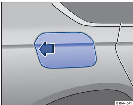
图 141 按压打开燃油箱盖板。
