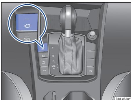
图 105 在中控台下部：电子驻车制动器按钮
