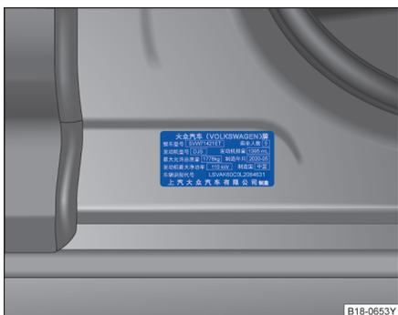
图 19 B 柱下方整车产品标牌
