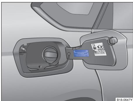
图 143 油箱加油口盖板内侧的标签
