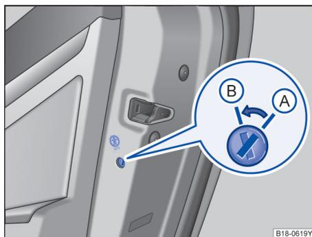
图 29 在右后车门中：儿童安全锁 (A) 已关闭、(B) 已接通
