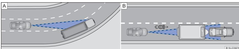
图 121 (A) 处在弯道里的轿车；(B) 前方便行驶的摩托车处在雷达传感器探测范围外
