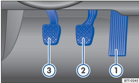
图 100 带手动变速箱的汽车上的踏板：①油门踏板②制动踏板③离合器踏板
