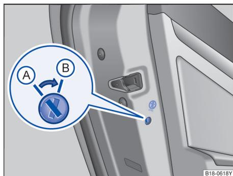
图 28 在左后车门中：儿童安全锁 (A) 已关闭、(B) 已接通
