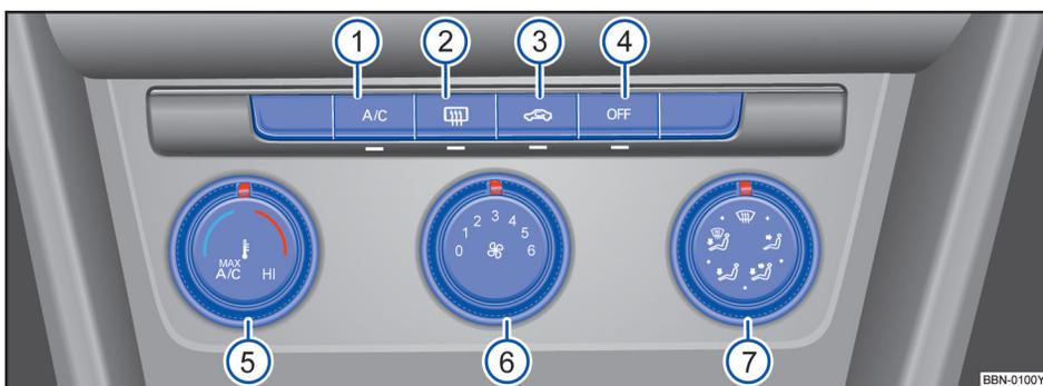
图 132 中控台上：电子手动空调的操作元件
