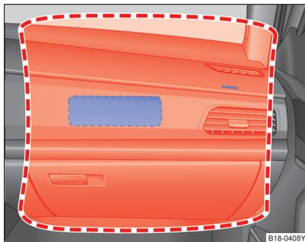
图 64 副驾驶前部安全气囊的安装位置和膨胀范围
