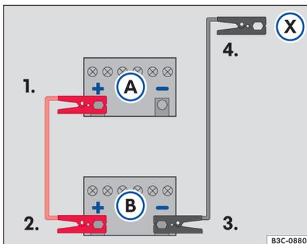
图 172 跨接电缆连接示意图
