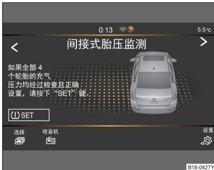
图 130 被动式轮胎气压监控系统设定
