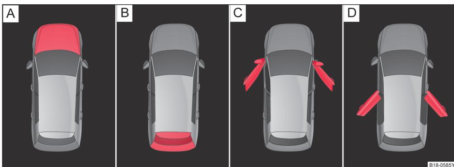
图 14 显示屏显示：(A) 发动机舱盖处于打开状态，(B) 行李厢盖处于打开状态，(C) 前车门处于打开状态，(D) 后车门处于打开状态
