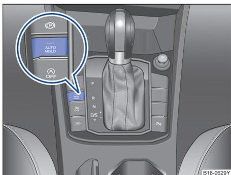
图 108 在中控台：自动驻车功能按钮
