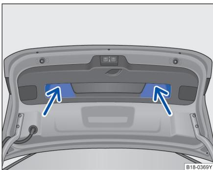
图 31 已打开的行李厢盖：用于关上的凹槽。
