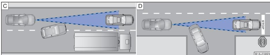
图 122 (C) 正在变换车道的其它车辆；(D) 正在转弯和处于静止状态的其它车辆
