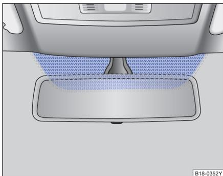
图 74 带通讯窗口（蓝色区域）的红外线反射金属镀层风窗玻璃
