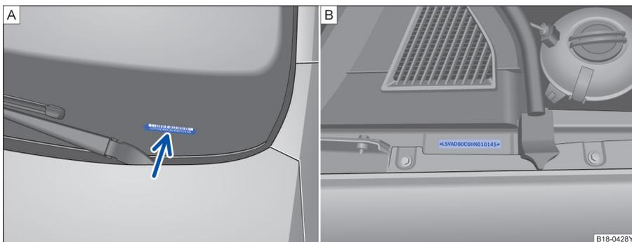
图 18 A 车辆识别代号 B 发动机舱内的车辆识别代号钢印位置
