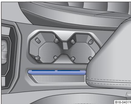
图 90 前部中控台的卡片插槽
