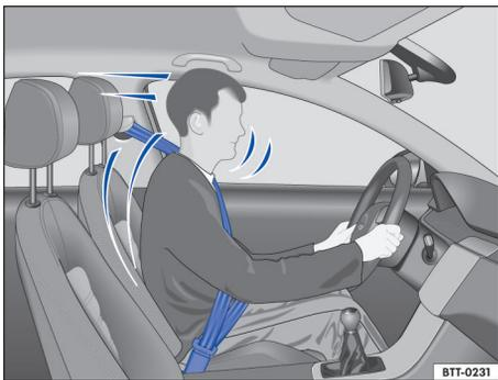
图 57 紧急制动时正确佩戴的安全带可有效保护驾驶员
