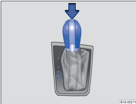
图 103 带锁止按钮（箭头所示）的自动变速箱选档杆
