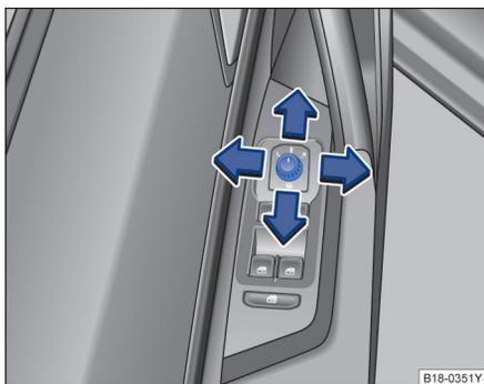
图 83 在驾驶员侧车门内：车外后视镜旋钮。
