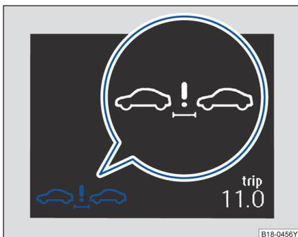
图 123 组合仪表显示屏中：车距预警显示
