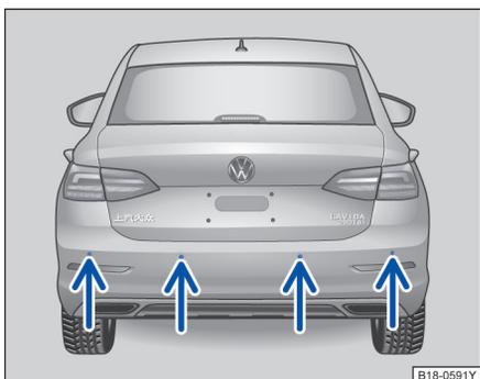
图 109 后部驻车距离探头位置
