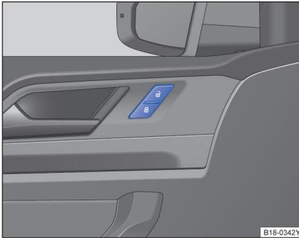
图 25 驾驶员侧车门内：中央门锁按钮。
