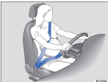
图 61 正确的孕妇安全带佩戴走向。
