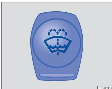
图 81 发动机舱内：风窗清洗液容器盖。
