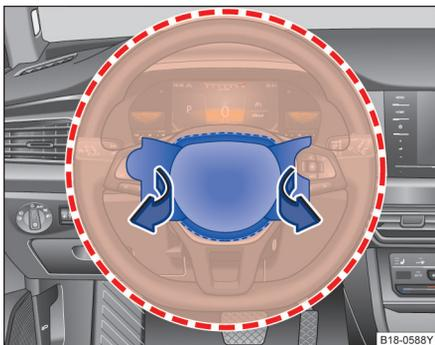
图 63 驾驶员前部安全气囊的安装位置和膨胀范围
