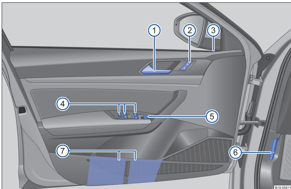
图 5 驾驶员侧车门内的操作元件概览
