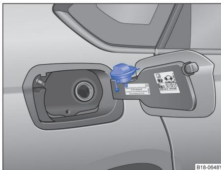
图 142 拧下的加油口盖可挂在打开的燃油箱盖板上
