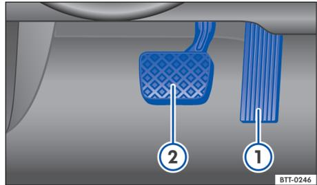
图 101 带自动变速箱的汽车上的踏板：①油门踏板、②制动踏板。
