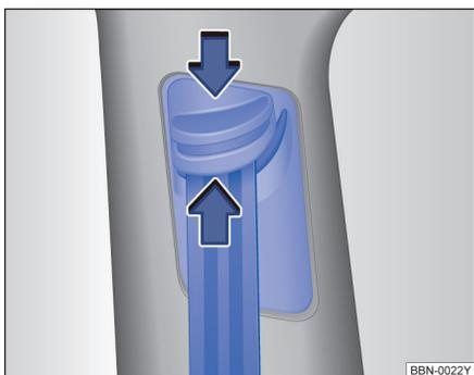
图 62 前座椅旁：安全带高度调整机构。
