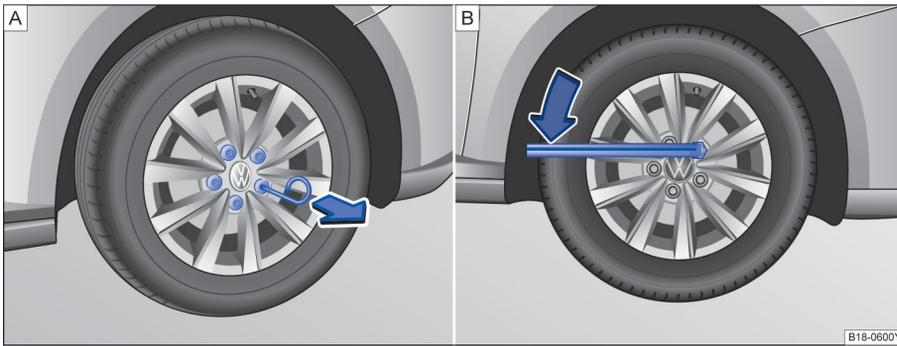
图 166 A. 从车轮螺栓上拔下盖罩，B. 更换车轮：松开车轮螺栓
