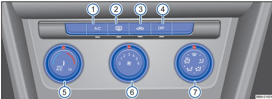
图 131 中控台上方：电子手动空调的操作元件
