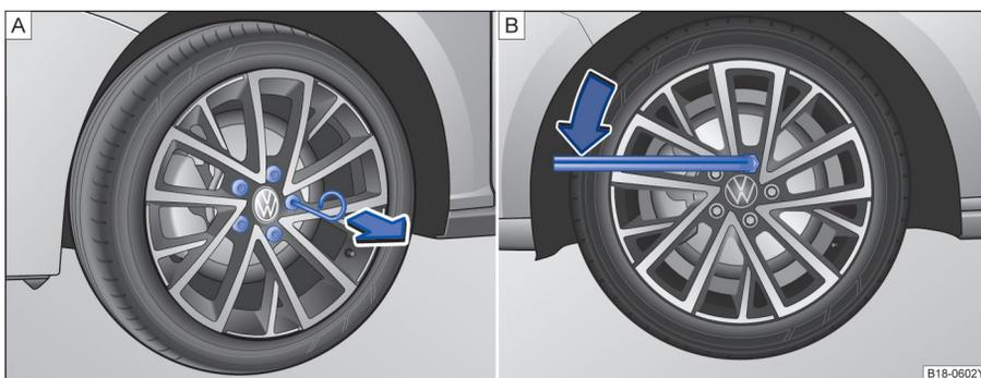
图 167 A. 从车轮螺栓上拔下盖罩, B. 更换车轮: 松开车轮螺栓
