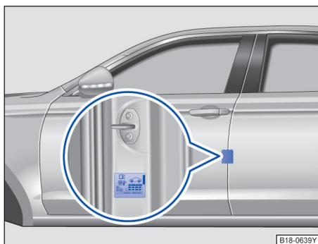
图 157 驾驶员侧中间门柱上：胎压标签（或者在油箱盖的内侧）
