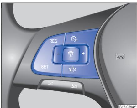
图 120 多功能方向盘左侧：自适应巡航系统 (ACC)
