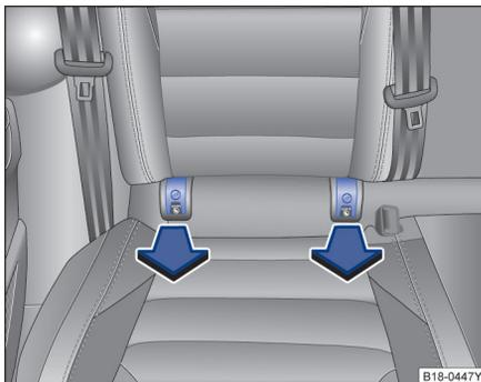
图 68 汽车座椅上：下部固定点护罩
