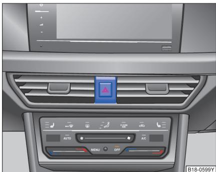
图 158 在中控台上上部分中：危险警报灯开关
