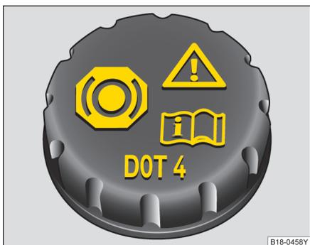
图 106 发动机舱内：制动液容器的盖子。
