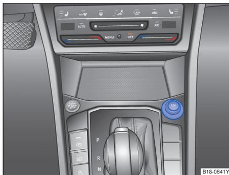
图 96 在前排中控台内：12 V 电源插座
