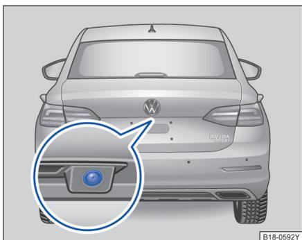
图 116 车辆行李厢盖内：倒车摄像头的安装位置
