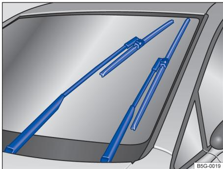
图 77 车窗玻璃刮水器在维护位置。
