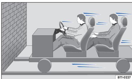
图 53 汽车驶向一砖墙，驾乘人员未系安全带
