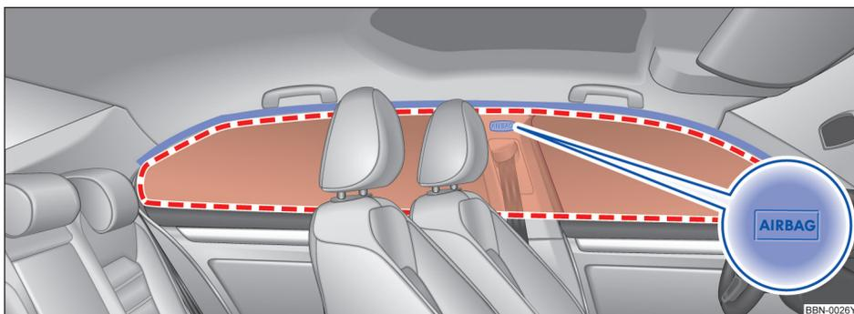
图 66 在汽车左侧：头部安全气囊的安装位置和膨胀范围
