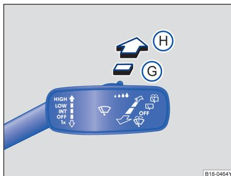
图 76 后风窗刮水器操纵杆操作位置。
