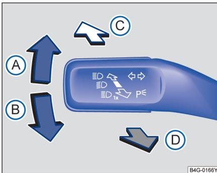
图 70 转向信号灯 / 远光灯操作杆。
