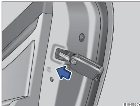
图 162 车门应急上锁装置及汽车钥匙
