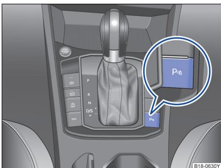
图 110 在中控台中：用于接通或关闭前后驻车距离报警系统的按钮
