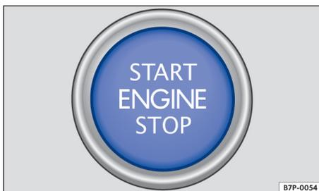
图 98 无钥匙系统 Kessy：中控台下部分中的启动按钮。
