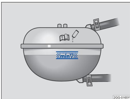
图 147 冷却液补偿容器上的液位标记
