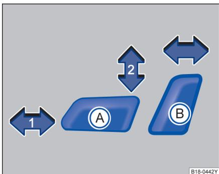
图 39 开关：调整座椅的前后位置、座椅面的高度
