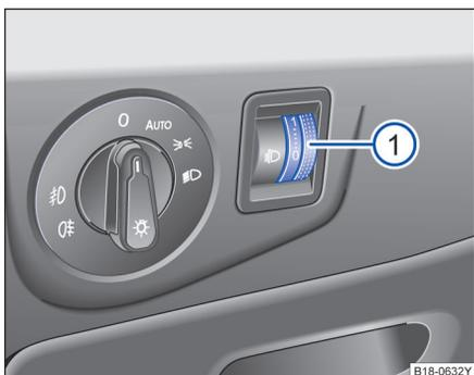
图 72 在方向盘旁边：大灯照明距离调节的调节器
