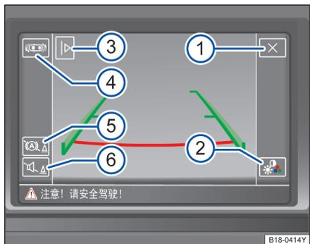
图 114 可视摄像头显示。显示画面视车型而定：某些车型的可视摄像头与前后驻车距离报警的图像不在同一画面中显示。
