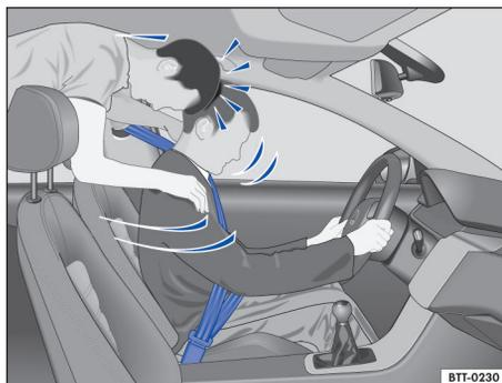
图 56 未系安全带的后排乘员被猛烈前抛，撞击佩戴安全带的驾驶员
