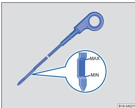
图 146 带液位标记的机油标尺
