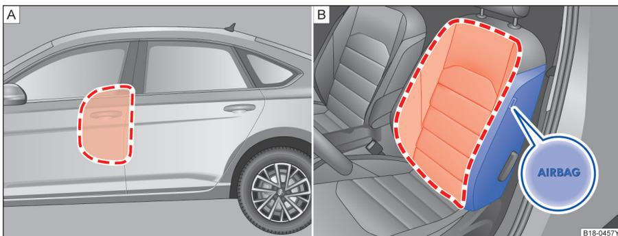
图 65 A: 轿车左侧 - 侧面安全气囊膨胀范围; B: 左前座椅侧面 - 侧面安全气囊安装位置及膨胀范围
