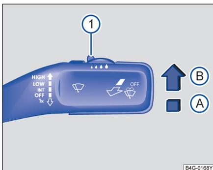
图 78 车窗玻璃刮水器操作杆：调节雨量传感器 ①。
