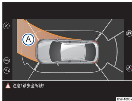
图 146 泊车雷达系统显示屏：施加转向时汽车行驶路径显示模式
