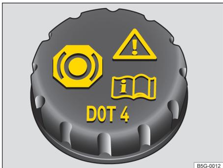
图 204 发动机舱内：制动液容器的盖子
