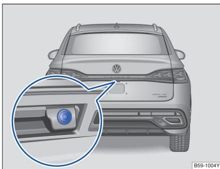
图 147 车辆行李厢盖内：倒车摄像头的安装位置
