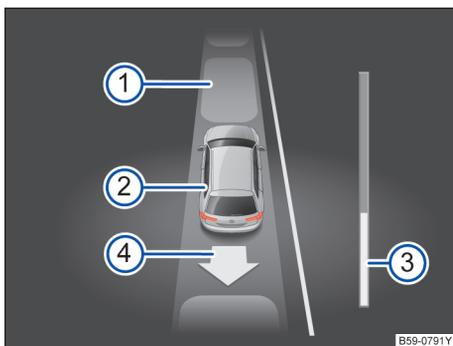
图 158 在组合仪表的显示器中：与车道平行的驶出
