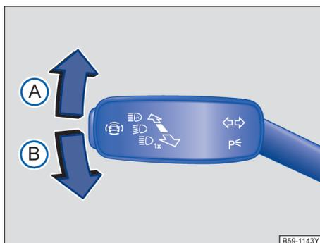
图 93 部分车型转向信号灯 / 远光灯操作杆
