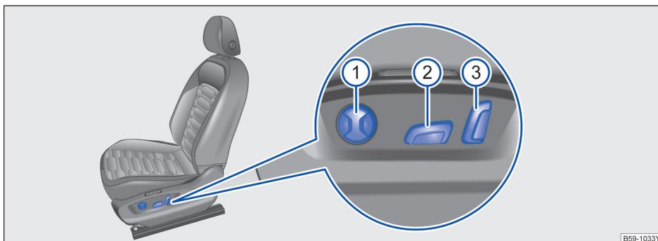
图 72 电动调整式座椅的操作元件
