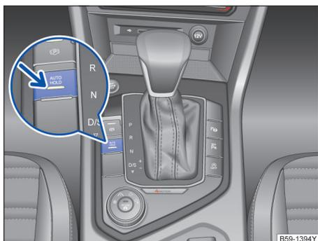
图 140 在中控台中：自动驻车功能按钮
