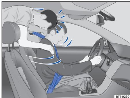
图 29 未系安全带的后排乘员被猛烈前抛，撞击佩戴安全带的驾驶员
