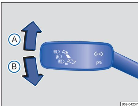
图 87 转向信号灯 / 远光灯操作杆
