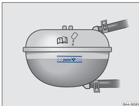
图 202 冷却液补偿容器上的液位标记
