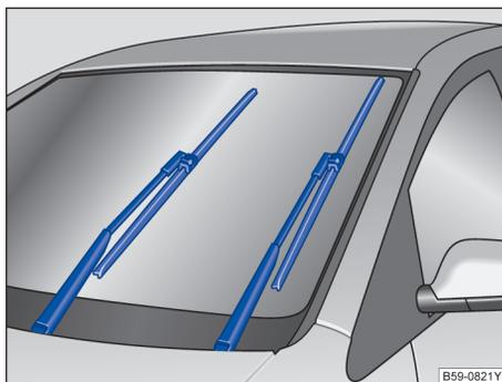
图 95 车窗玻璃刮水器在维护位置
