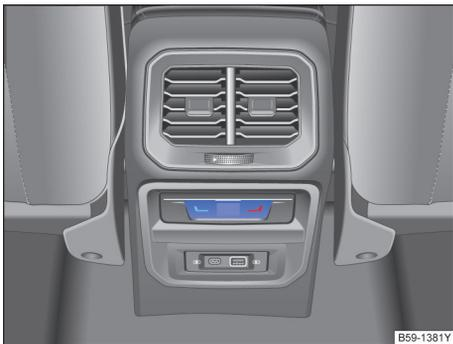
图 103 部分车型在后部中控台：用于调节后排座位温度的操作元件
