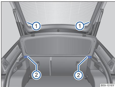
图 174 拆卸和安装行李厢盖板
