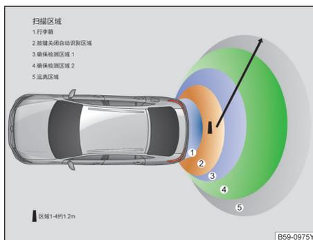
图 63 感应式行李厢盖开启和关闭钥匙有效识别区域
