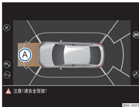
图 145 泊车雷达系统显示屏：未施加转向时汽车行驶路径显示模式
