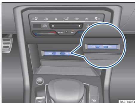
图 166 前部中控台下部储物盒内的 USB、Type-C 插口
