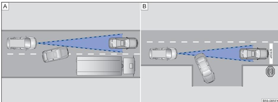
图 126 A. 正在变换车道的其它车辆 B. 正在转弯和处于静止状态的其它车辆
