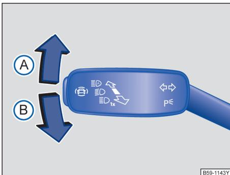
图 88 部分车型转向信号灯 / 远光灯操作杆
