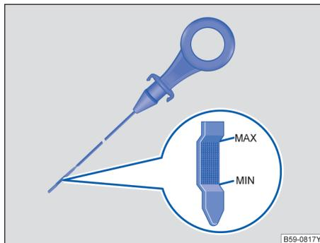
图 201 带液位标记的机油标尺
