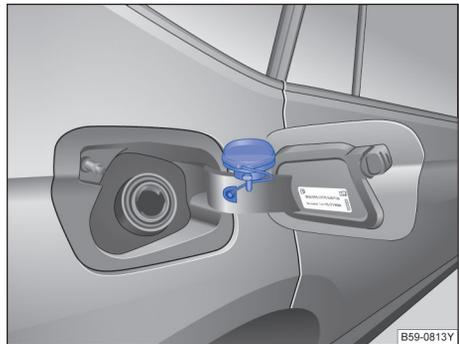
图 184 拧下的加油口盖可挂在打开的油箱盖板上
