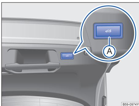
图 62 打开的行李厢盖内：用于电动关闭行李厢盖的按钮
