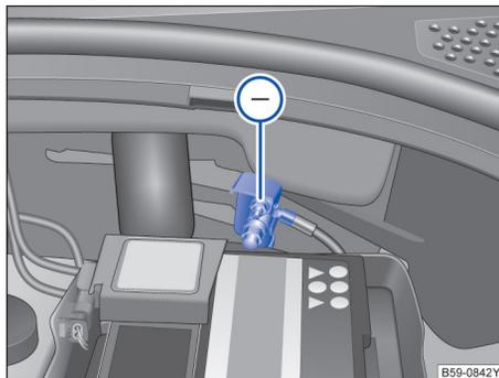
图 192 用于充电器负极连接的接地点
