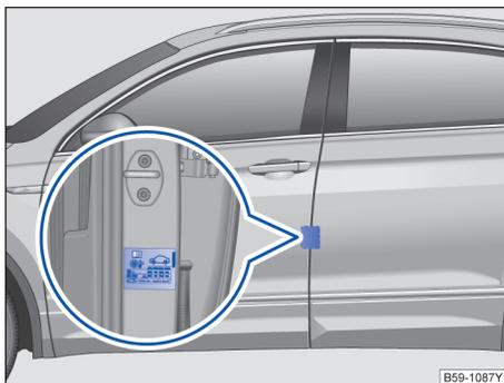
图 211 驾驶员侧中间门柱上：胎压标签（或者在油箱盖的内侧）
