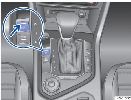
图 139 在中控台下部：电子驻车制动器按钮
