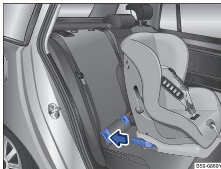
图 42 原理图：安装带固定臂的 ISOFIX 儿童座椅
