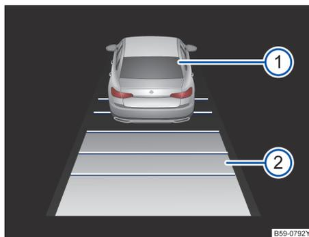
图 121 组合仪表显示屏：已暂时关闭自适应巡航系统（ACC）控制功能，已探测到的前方车辆，设定的距离间隔
