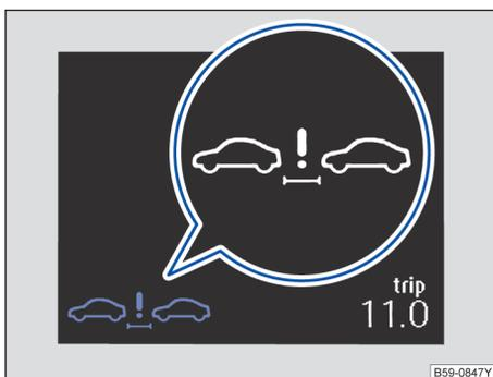
图 128 组合仪表显示屏中：车距预警显示
