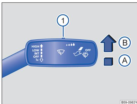
图 96 车窗玻璃刮水器操作杆：调节雨量传感器 ①
