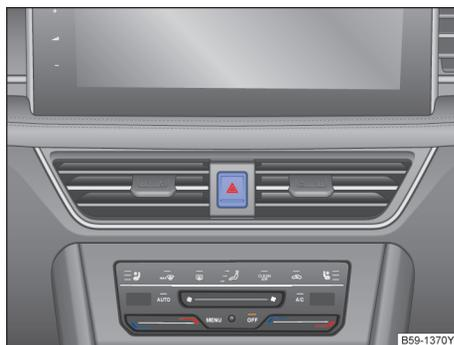
图 44 在中控台上部分中：危险警报灯开关
