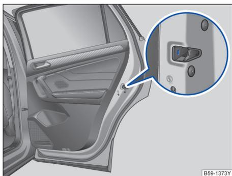
图 57 右侧后车门门锁内的应急上锁装置
