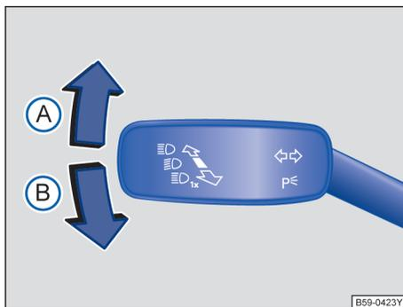
图 92 转向信号灯 / 远光灯操作杆
