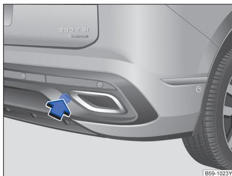
图 195 在保险杠右后部：拆卸盖板
