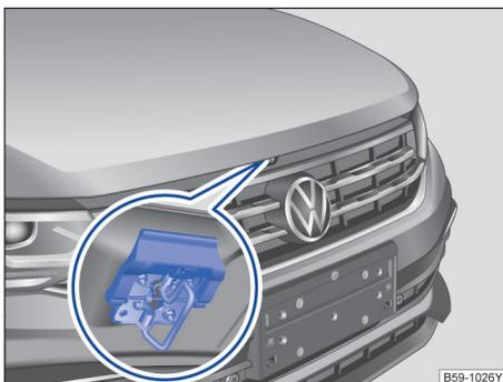
图 198 散热器格栅上方用于打开发动机舱盖的分离杆
