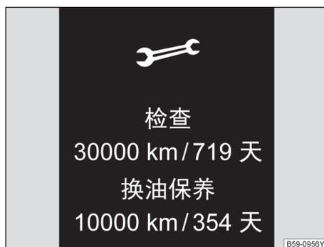
图 17 示意图：组合仪表显示屏显示的保养信息示例
