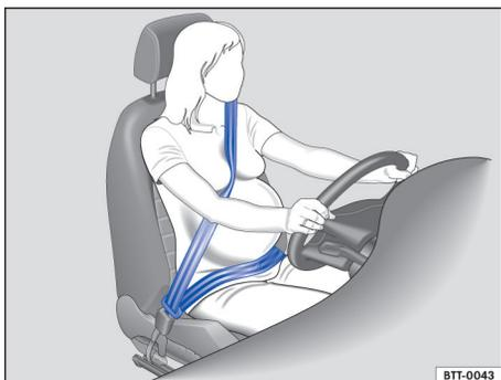
图 34 正确的孕妇安全带佩戴走向
