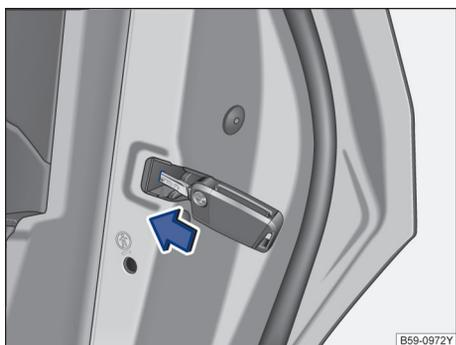
图 58 车门应急上锁装置及汽车钥匙
