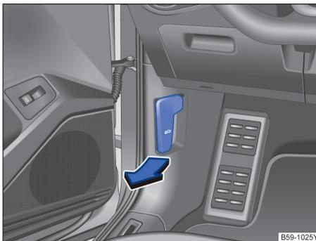
图 197 驾驶员侧脚部空间：发动机舱盖锁开启手柄 ▶
