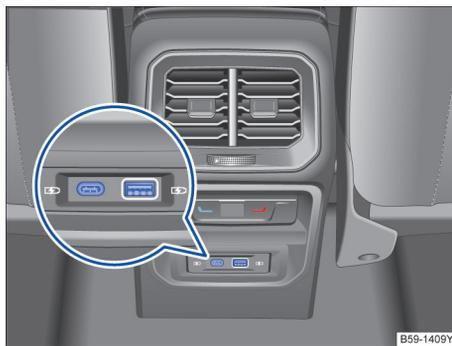
图 167 部分车型后部中控台下部 USB、Type-C 插口
