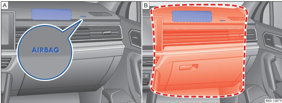
图 37 副驾驶前部安全气囊的安装位置和膨胀范围
