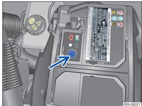
图 205 汽车蓄电池上侧的视窗（示意图）
