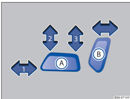
图 73 开关：调整座椅的前后位置、座椅面的高度和倾斜角度
