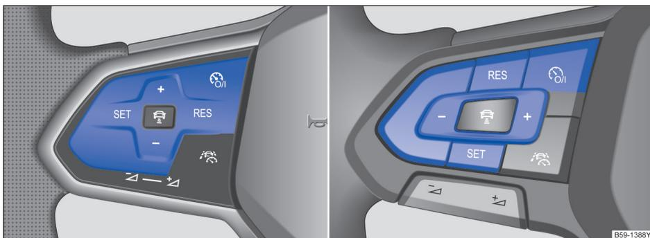
图 119 车速限速器操作按钮
