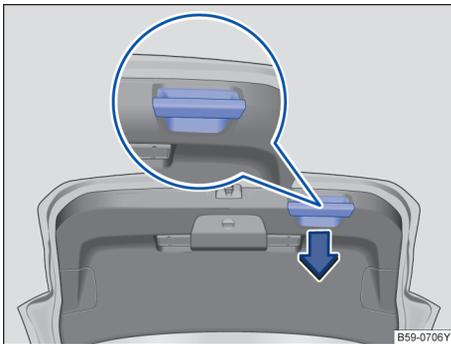
图 61 已打开的行李厢盖：用于拉动关闭的拉手
