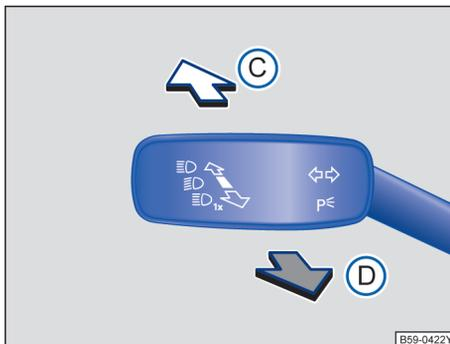
图 90 转向信号灯 / 远光灯操作杆
