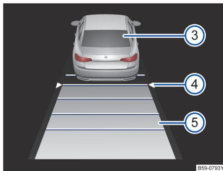
图 122 组合仪表显示屏：自适应巡航系统（ACC）处于激活状态，已探测到前方车辆，正在设定距离间隔
