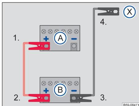
图 191 跨接电缆连接示意图
