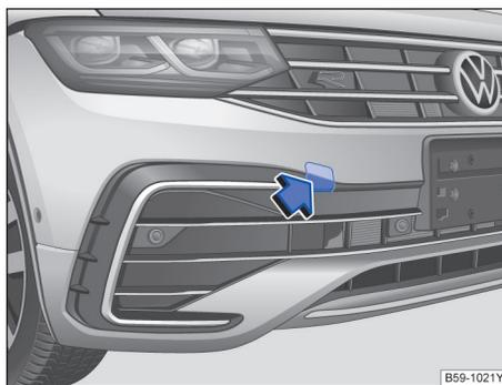
图 193 在保险杠的右前部：拆卸盖板
