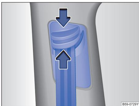
图 35 前座椅：安全带高度调整机构
