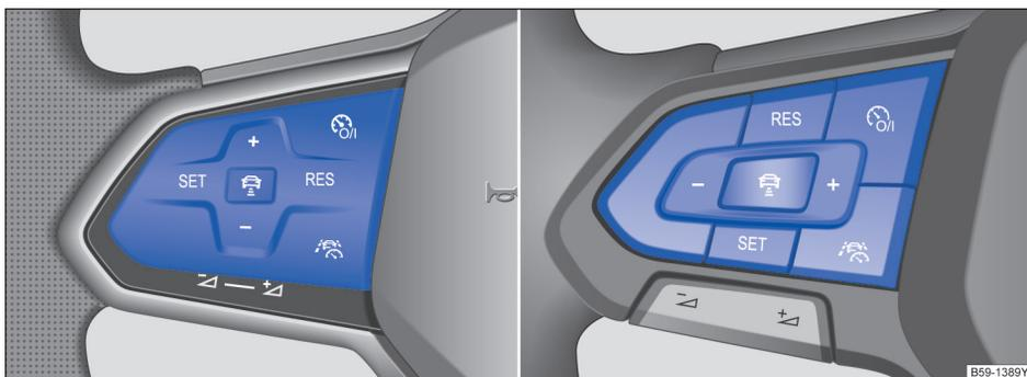
图 133 多功能方向盘左侧：操作全程智能驾驶辅助系统 (Travel Assist) 的按钮
