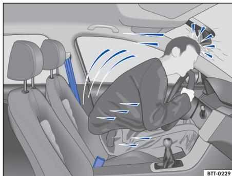
图 28 碰撞时未系安全带的驾驶员被猛烈抛向前方
