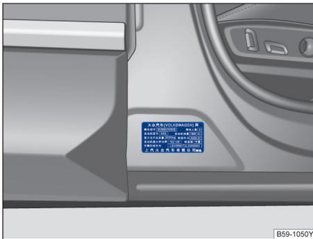
图 218 B 柱下方整车产品标牌
