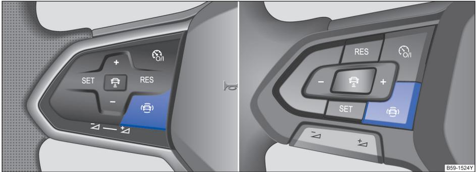
图 20 多功能方向盘左侧的驾驶辅助系统操作按钮
