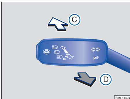
图 91 部分车型转向信号灯 / 远光灯操作杆
