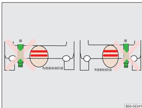
图 66 踢腿动作发生在传感器检测区域外
