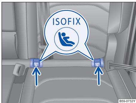
图 41 汽车座椅上的儿童座椅下部固定点标记
