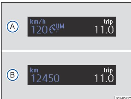
图 120 组合仪表显示屏：车速限速器状态显示模式
