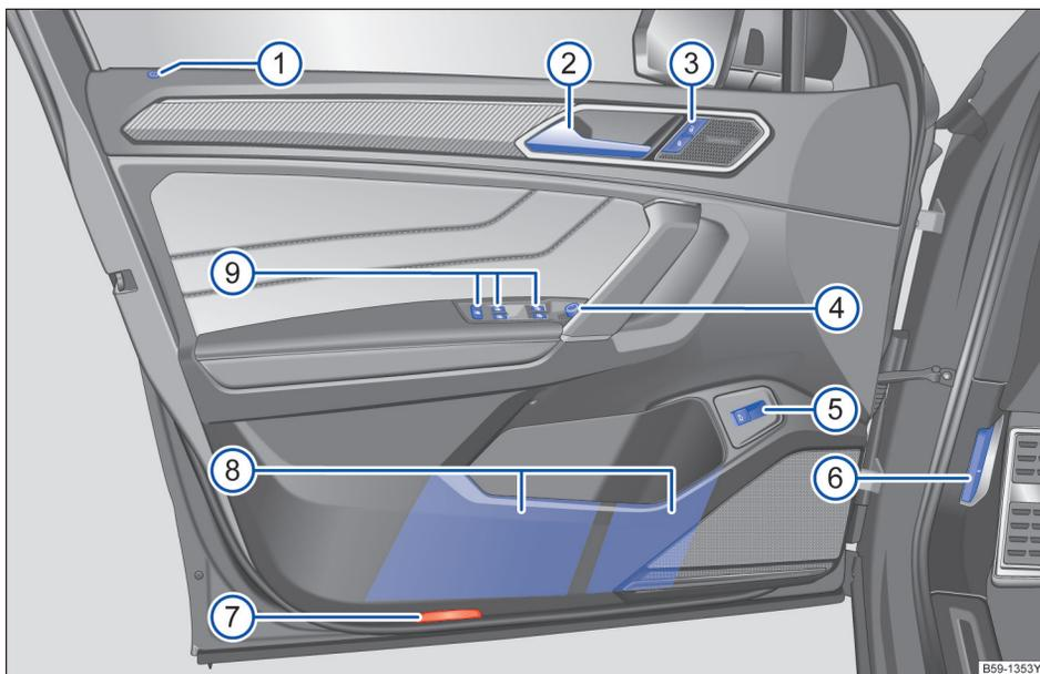
图 4 驾驶员侧车门内的操作元件概览
