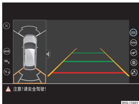
图 144 显示屏显示：车周区域泊车雷达系统缩微图像
