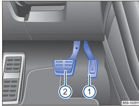
图 105 带自动变速箱的汽车上的踏板：① 油门踏板、② 制动踏板
