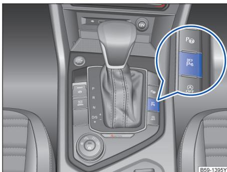
图 150 在中控台中：用于手动打开全景影像系统的按钮
