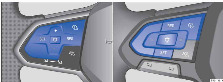
图 124 自适应巡航系统（ACC）控制按钮
