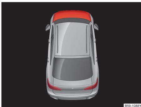
图 199 在组合仪表的显示屏上：发动机舱盖打开或未正确关闭
