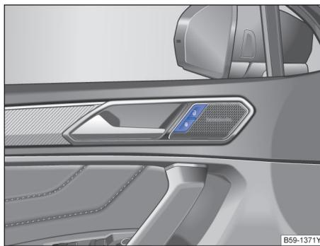
图 51 驾驶员侧车门内：中央门锁按钮
