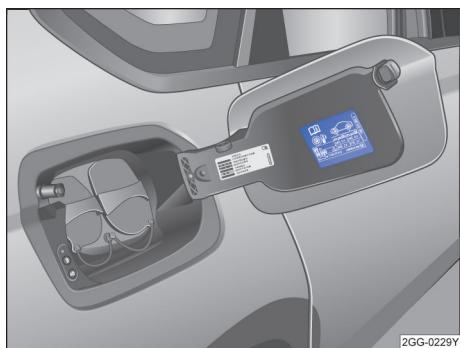
图 156 高压电池充电盖板内侧上：胎压标签
