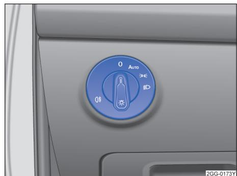
图 71 仪表板局部视图：灯光开关
