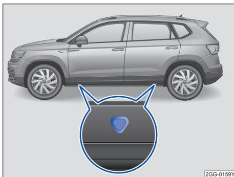
图 158 汽车底板：千斤顶的支撑点
