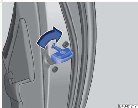
图 53 车门应急上锁装置及汽车钥匙
