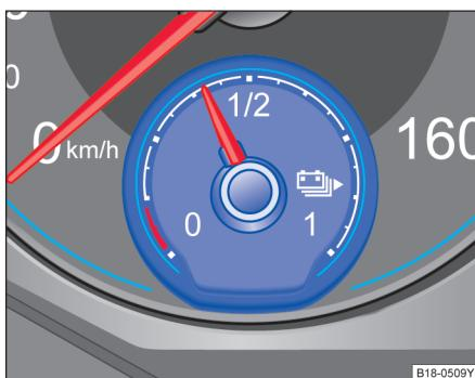
图 125 在组合仪表上：高压蓄电池的电量表和备用电量区域
