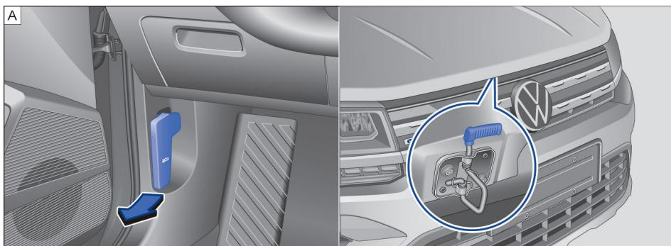
图 148 ① 驾驶员侧脚部空间：发动机舱盖锁解锁手柄 ② 散热器格栅上方用于打开发动机舱盖的拉杆
