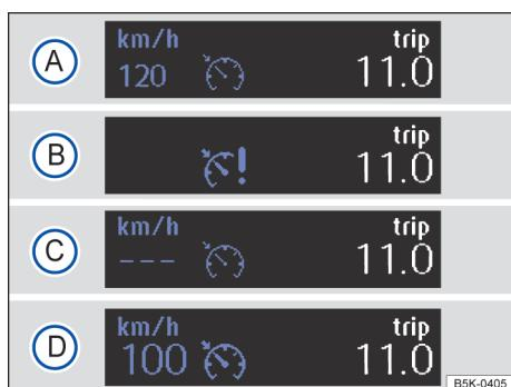
图 101 组合仪表显示屏：定速巡航系统状态显示模式
